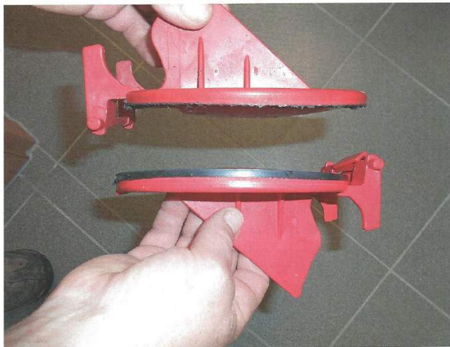
Der Nagetrieb von Wanderratten macht auch vor den Dichtungen der Rückstauklappen keinen Halt.
